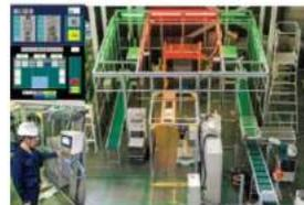
陸上の製造現場の例、遠隔操作と防護柵やインタロック等によって、作業者と危険源とを隔離している。
